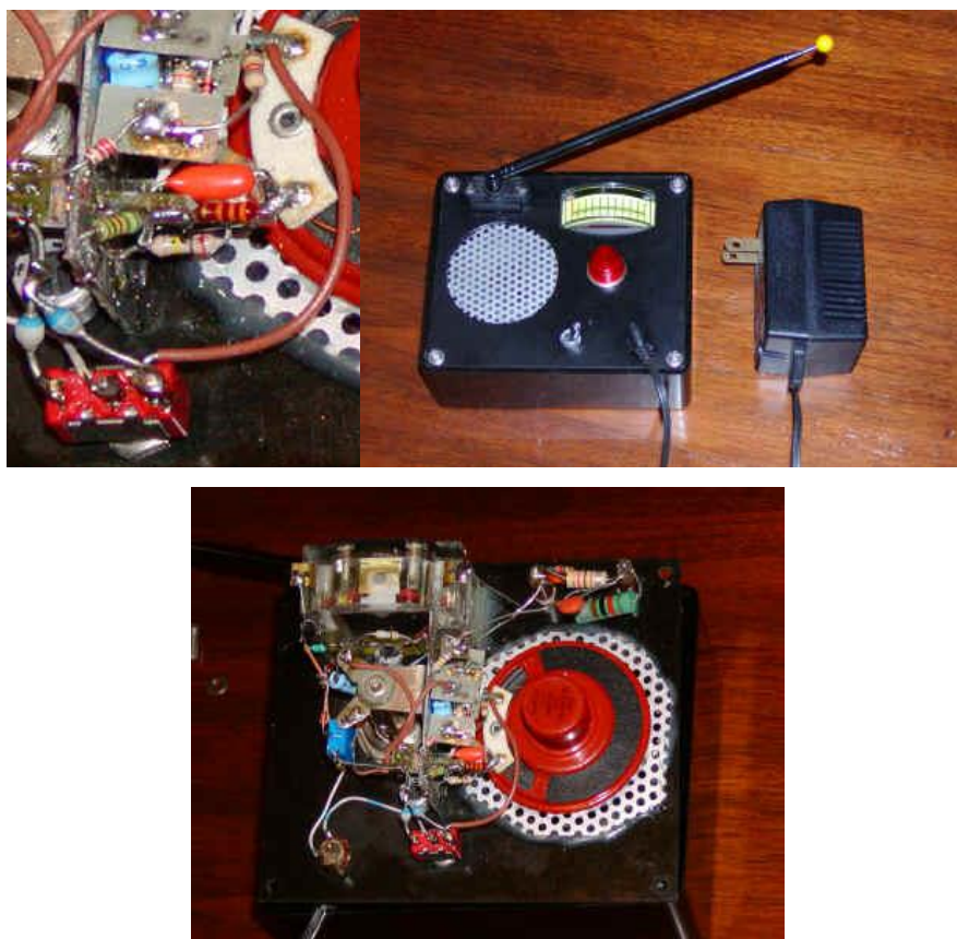
Слика 3.4. Изглед направљеног уређаја за детекцију АП
