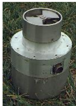
Slika 3.14. Field-mill сензор за мерења јачина електростатичких поља на великим висинама.
