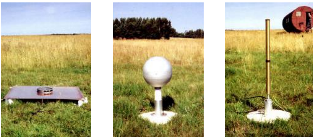
Слика 3.11. Разне врсте детектора за мерење спорих промена поља у фреквентном опсегу од 0.0001– 1 Hz на локацији мерења
