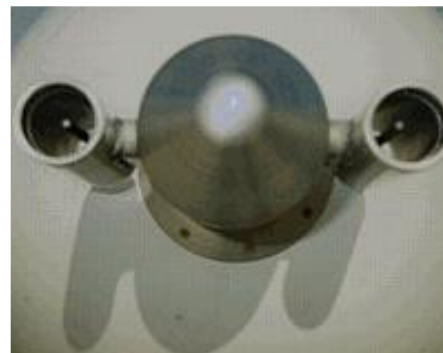
Slika 3.15. Сонде за мерење електричне проводности атмосфере
